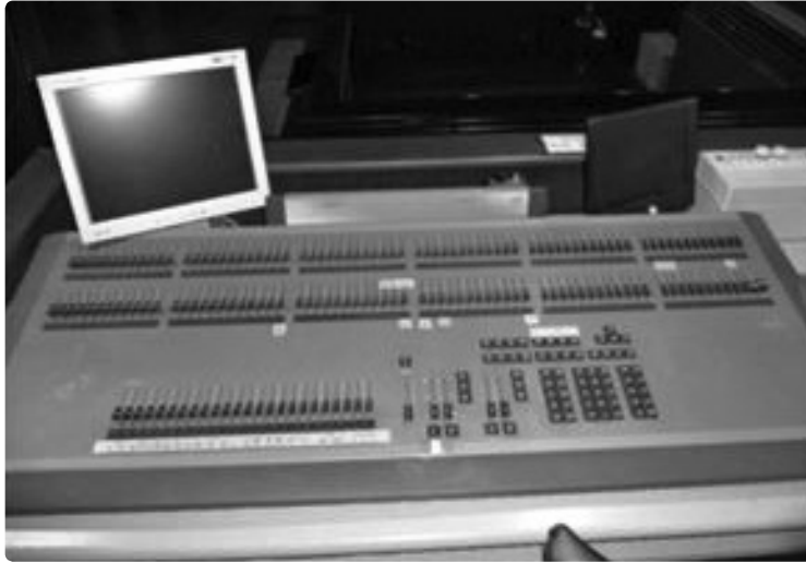
콘솔 설치상태 확인(오작동을 방지하기 위해 라벨 부착)
