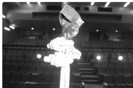
[그림 9] 간섭으로 인한 와이어로프 파손(불량)
