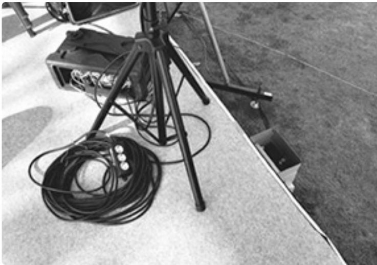
무대바닥 끝에 스탠드형 스피커 설치 되어 전도 및 낙하 위험
